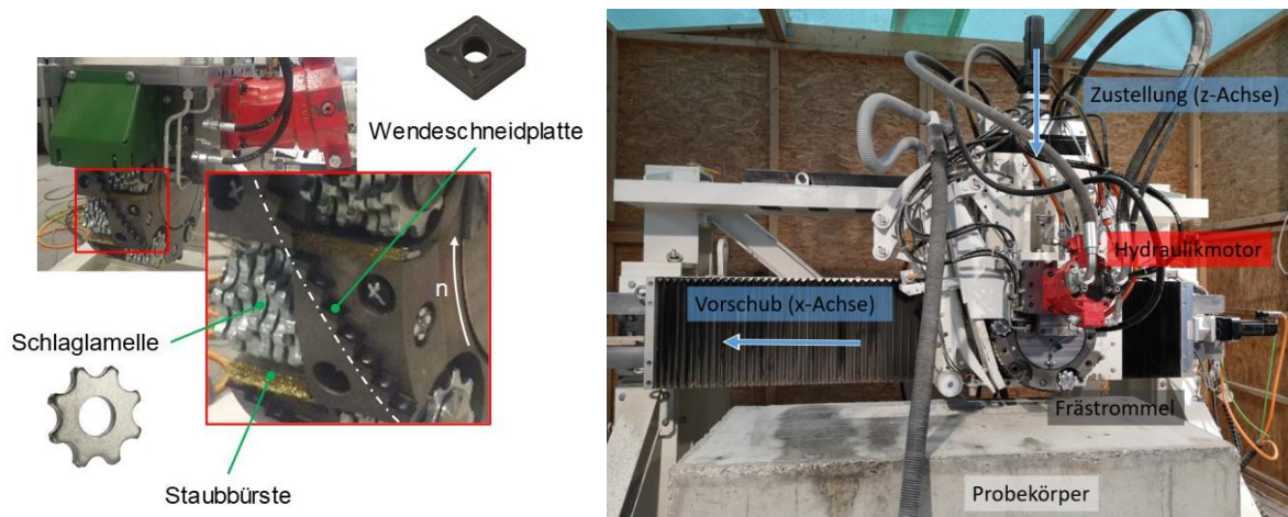
Abbildung 1: DefAhS-Frästrommel im Detail (l.) / DefAhS-Versuchsstand am KIT-TMB (r.)
