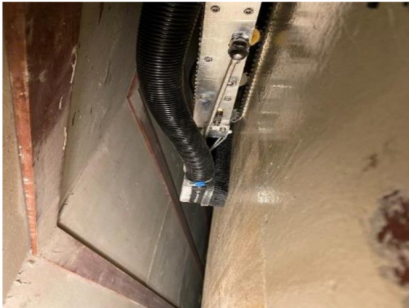
Abbildung 2: Inspektionscrawler mit Reinigungsbürste und kontinuierlicher Absaugung
