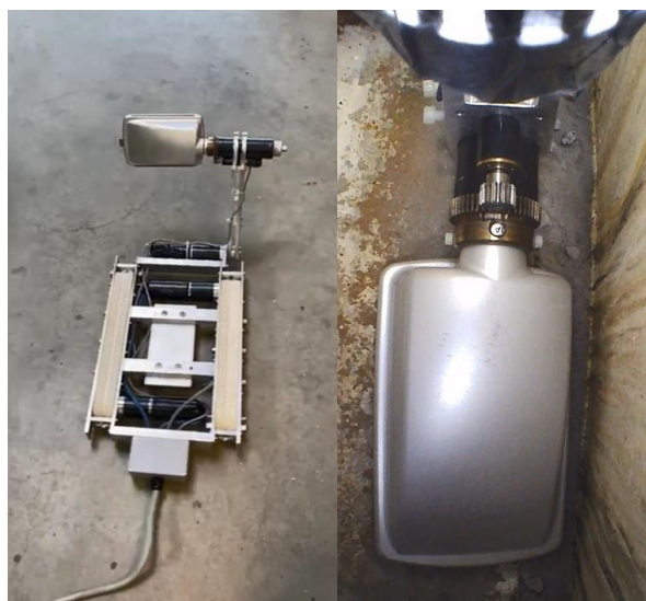
Abbildung 4: Inspektionscrawler mit einer Flachsonde ESD 170 (links) und Messung an der Bodenfläche der ESS (rechts).
