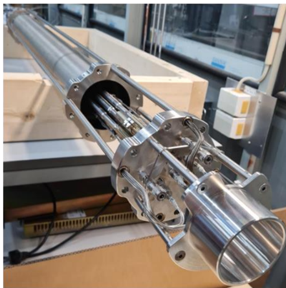
Abbildung 2: Blick auf den geöffneten Teststand. In der Mitte des Bildes sind drei der insgesamt acht im Quadrat angeordneten Teststäbe zu sehen.
