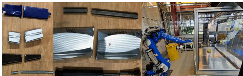
Abbildung 6: Werden massive Teile wie Aluminiumprofile, Lochbleche, Gewindestangen oder Meisel aus gehärtetem Stahl geschnitten (links), können abgeschleuderte Stücke in einer lokalen Einhausung aufgefangen werden (rechts).
