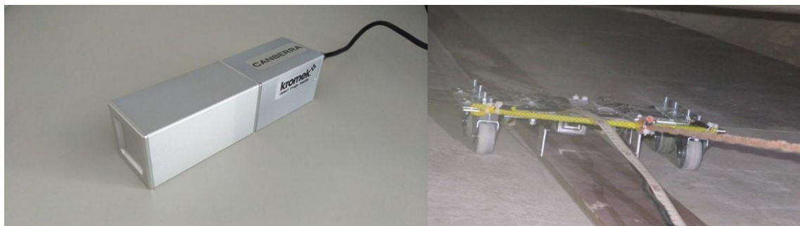
Abbildung 3: Gammaspektrometrischer Detektor Sigma-50 (links) und Messung am T-Träger mit einem Messwagen (rechts).
