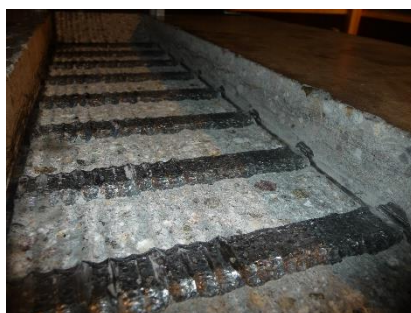
Abbildung 3: Schnittkanal aus Versuchen am KIT-TMB
